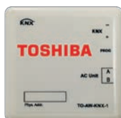
BMS-IFKX0AWR-E Rozhranie KNX®, napojenie na systém správy budov, skupinové riadenie až 8 jednotiek
